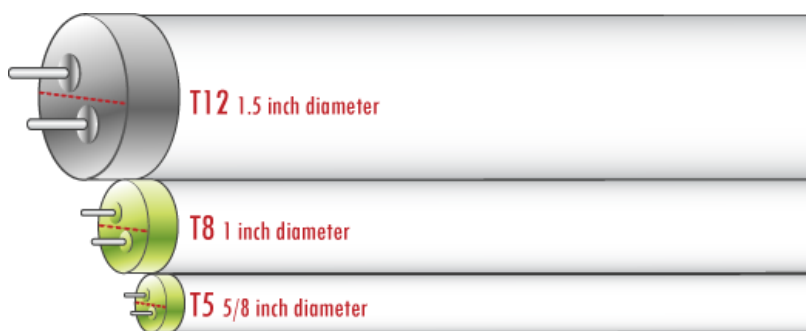
Slika 28: Prikaz sprememb premerov fluorescenčnih sijalk T12, T8 in T5
