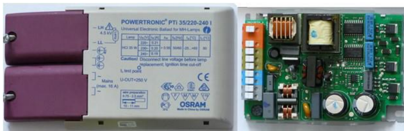
Slika 54: Elektronska predstikalna naprava za visokotlačne sijalke
