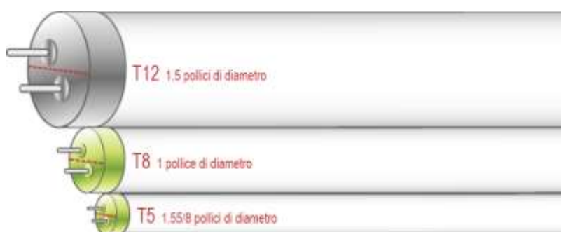
Figura 28: Esempio dei cambiamenti nei diametri delle lampade fluorescenti T12, T8 e T5
